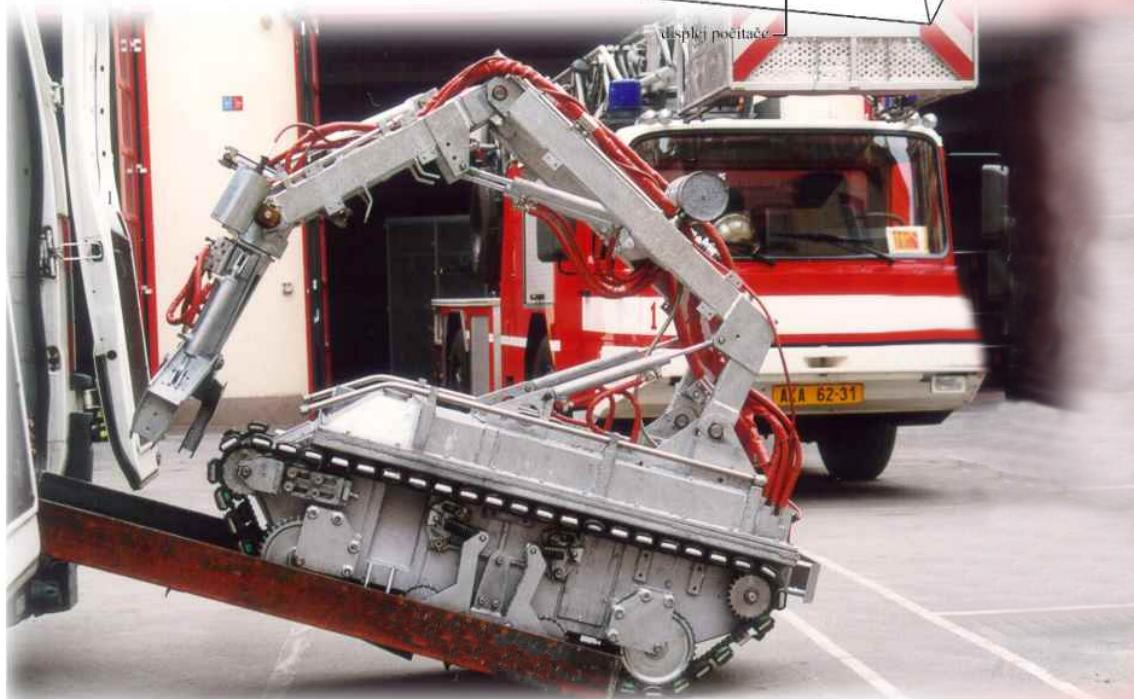
Operátorský panel je s robotem spojen bezdrátově nebo pomocí kabelu, což umožňuje práci i ve velmi silně rušeném prostředí, nebo tam, kde se špatně šíří radiový signál.
