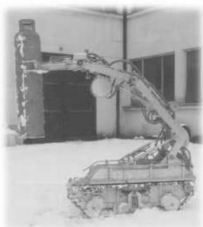
Pohon obstarávají dva elektromotory pro pohyb pášů a hydraulický agregát, který přes elektrohydraulické rozvaděče pohání válce paže.
